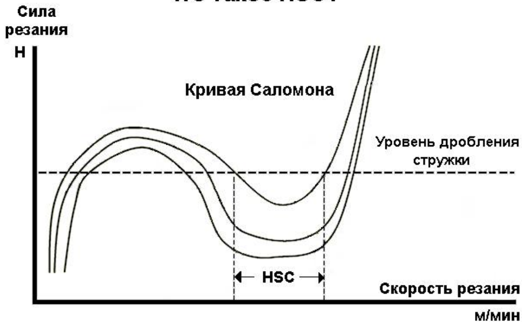
Рис. 1. Изменение сил резания с увеличением скорости резания
