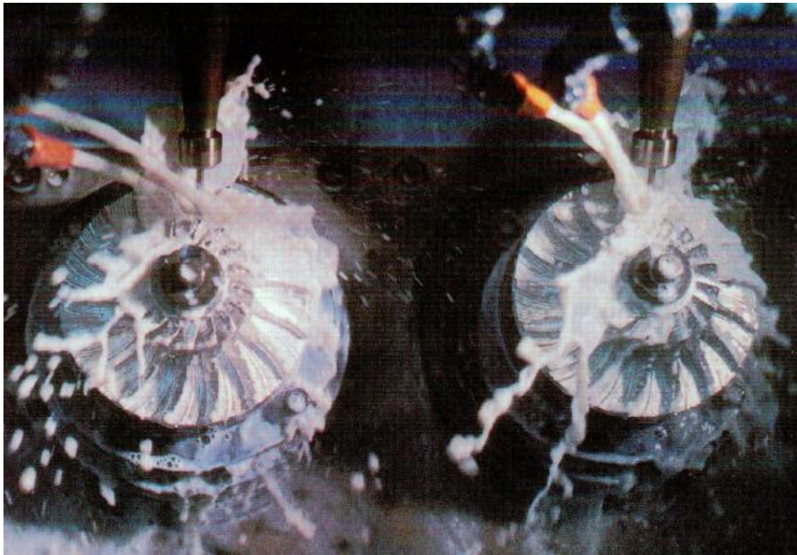
Рис. 4.: Обработка лопастей рабочего колеса на обрабатывающем центре, оснащённом моторшпинделем IBAG HF140. Фото из журнала „American Machinist & Automated Manufacturing“
