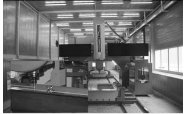
Рис. 7. Отслеживание сварного шва на портальном обрабатывающем центре HAGEMATIC 305 FSW для обработки резанием и СТП
