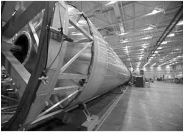
Рис. 6. Резервуар ракеты-носителя «Falcon 9» из алюминиево-литиевого сплава (предприятие «SpaceX»), продольные и круговые швы которого сделаны с помощью СТП. При этом полностью исключается формирование водородных пузырей (режим доступа: http://en.wikipedia.org/wiki/File:SpaceX_factory_Falcon_9_booster_tank.jpg )
