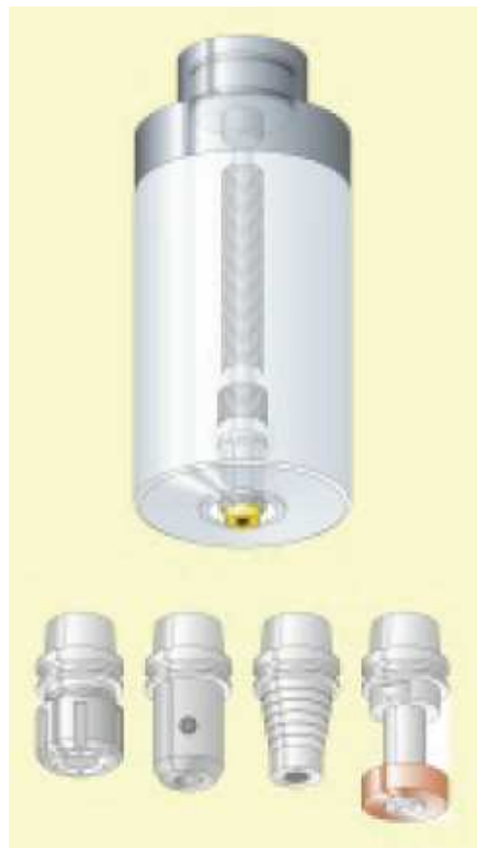
Рис. 9. Встроенная система зажима HSK по DIN 69893 может использоваться с прецизионными цангами, оправками Weldon, патронами, работающими по принципу „горячей усадки», или фовальными оправками
