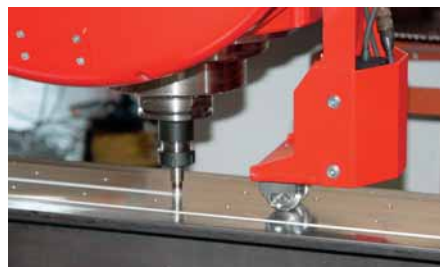
Рис. 4 Сварка трением с перемешиванием алюминиевых профилей с системой контроля качества сварного шва SCOUT
