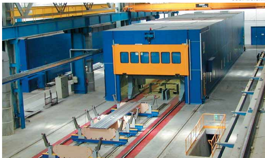
Рис. 1 Пятиосевой порталный обрабатывающий центр HAGEMATIC 305
