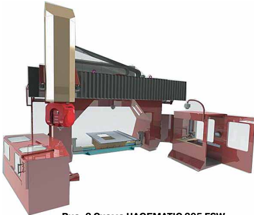
Рис. 2 Схема HAGEMATIC 305 FSW для операций HSC и FSW
